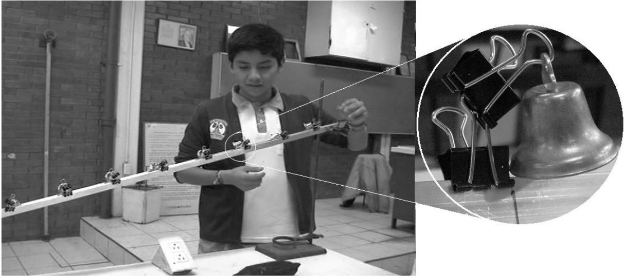
Figura 3.1 Configuración del sistema: plano inclinado
